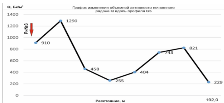
Рисунок 9. График изменения объемной активности почвенного радона Q вдоль профиля G5
